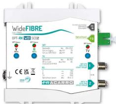
Receptor de fibra óptica que convierte la señal óptica del emisor OPT-TX WB1 en una señal coaxial. Dispone de 2 salidas SCD2 multiestándar (SCR/dCSS/dSCR-BSkyB y legacy) con la señal de TV mixta.
